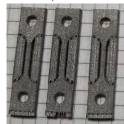
Figure 1 – Eprouvettes de traction obtenues par SLM
